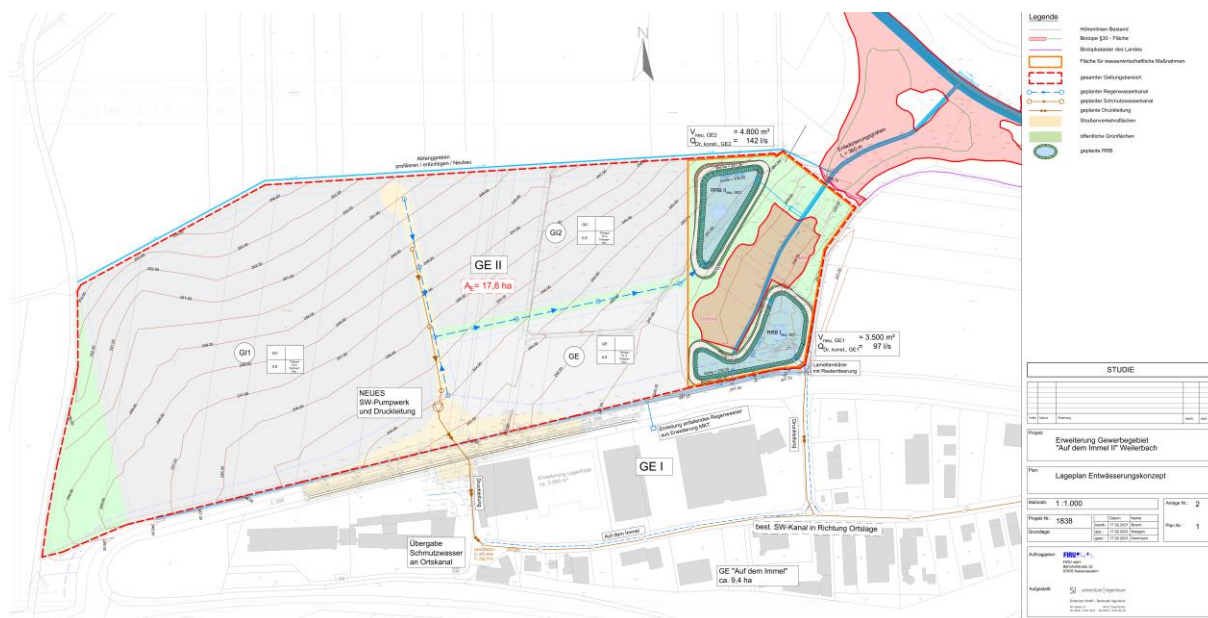
Abbildung 6: Lageplan Entwässerungskonzept; Schweitzer Ingenieure, Stand 03/2020.
