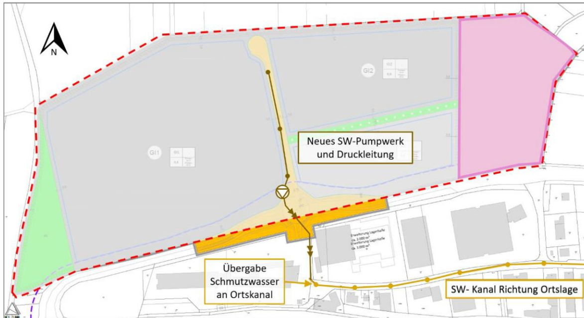
Abbildung 8: geplante Schmutzwasserentwässerung; Schweizer Ingenieure, Stand 03/2020.
